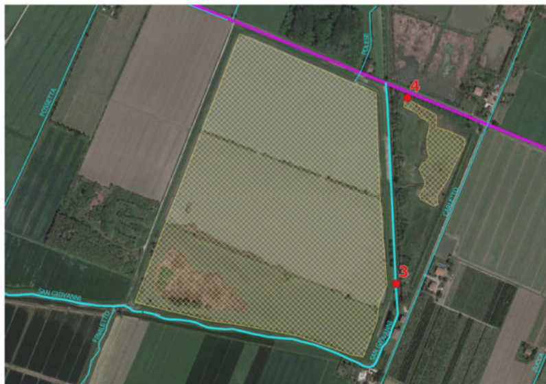
Figura 2: Evidenziate a tratteggio: a sinistra, cassa di espansione; a destra, area fitodepurante. Fra le due, il percorso del canale San Giovanni. A sud-ovest, poco prima della cassa, è' anche visibile l'immissione del canale Finaletto nel San Giovanni. I punti identificati coi numeri 3 e 4 corrispondono a due dei quattro punti di campionamento acque sul canale di San Giovanni e nell'area fitodepurante.
