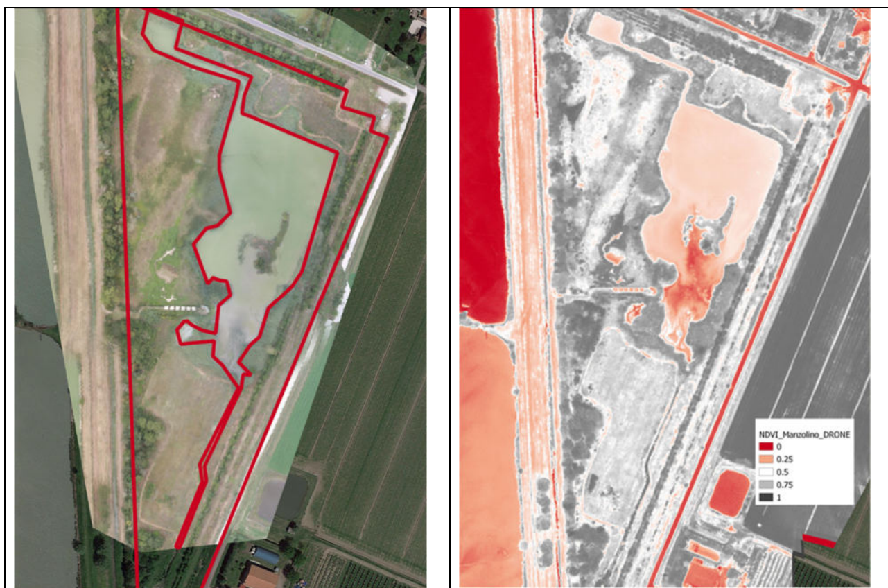
Figura 7: A sinistra: immagine da ortofoto dell'area fitodepurante, con delimitazione del bacino e, in basso, della canaletta di adduzione delle acque; a destra: la stessa zona, rilevata da drone con sensore multispettrale ed evidenziazione della variazione dell'indice NDVI.
