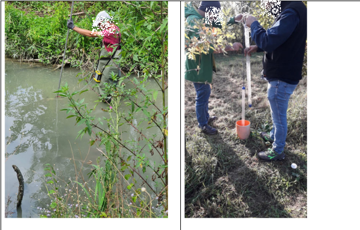
Figura 4: A sinistra: operazioni di misura del flusso idrico sul canale di San Giovanni tramite mulinello idrometrico; a destra: prelievo rapido acque di falda dal piezometro per l'esecuzione di una prova di slug test.
