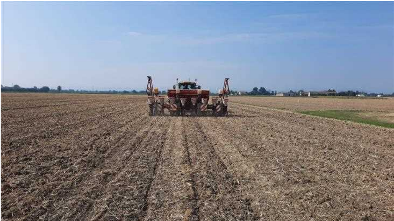
Figura 30. Semina del mais con sistema di posizionamento RTK per seguire le linee dello strip-tiller .
