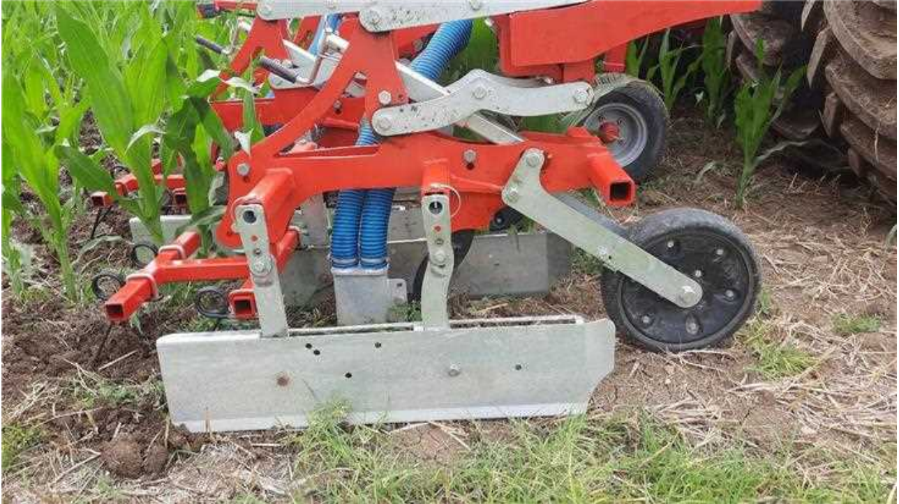
Figura 31. Dettaglio dell'apparato di iniezione del liquame in copertura sul mais.
