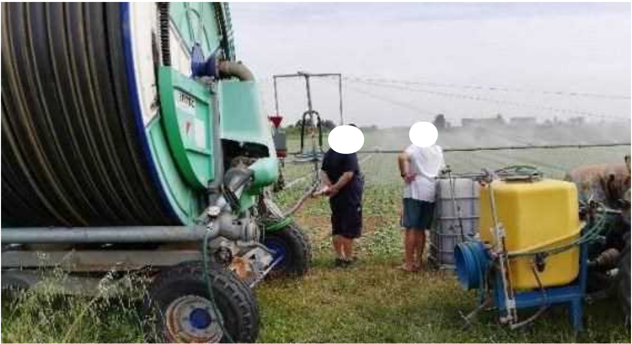
Figura 13. Sistema di iniezione della soluzione di solfato ammonico nella linea di irrigazione
