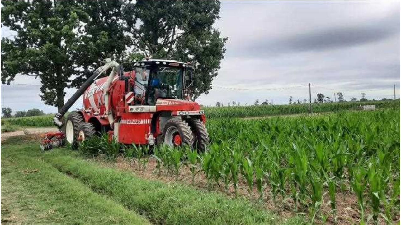
Figura 32. Dettaglio della configurazione a ruote sfalsate per permettere il passaggio nel mais senza calpestarlo.
