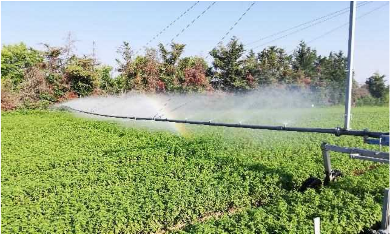
Figura 11. Primo piano dell'ala piovana e degli ugelli aspersori
