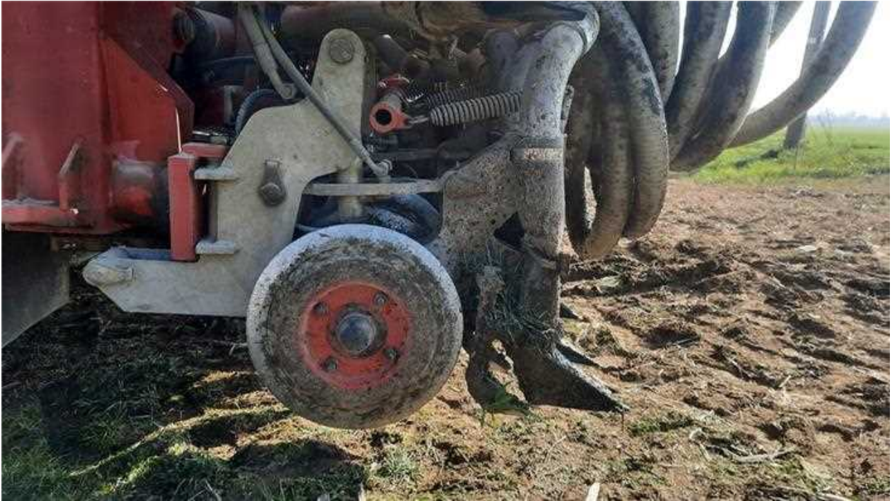
Figura 27. Dettaglio del disco di taglio e della scarpetta di iniezione del liquame nel solco.
