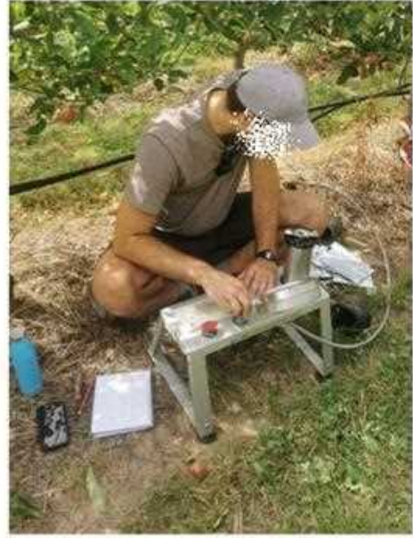
Foto 1 - Misurazione degli scambi gassosi attraverso Li-COR 6800 (sinistra) e potenziale idrico con camera di Scholander (destra)
