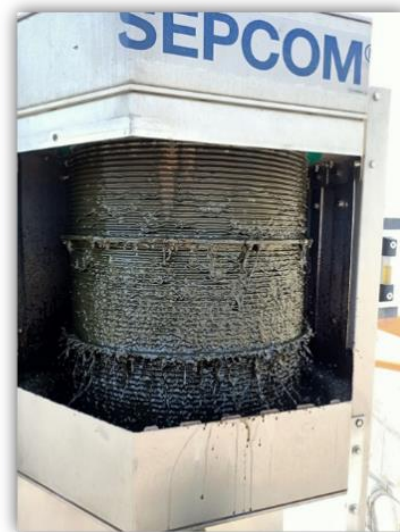
Figura 3. Illustrazione dell'impianto con separatore a compressione elicoidale solido/liquido (a sinistra) e microfiltro (a destra) installato presso l'azienda Leona
