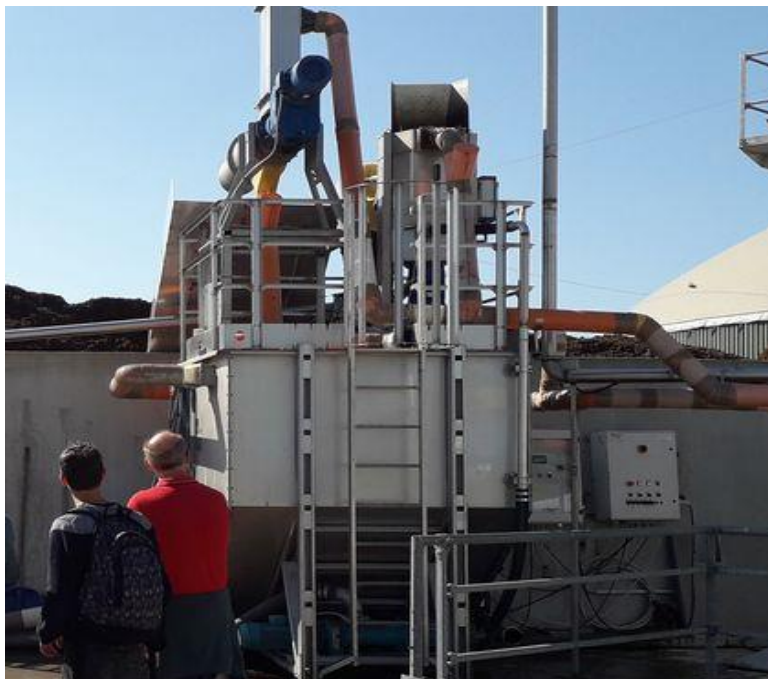
Figura 4. Illustrazione dell'impianto con separatore a compressione elicoidale solido/liquido (in alto a sinistra) e microfiltro (sul lato a destra) installato presso l'azienda R.G.R.
