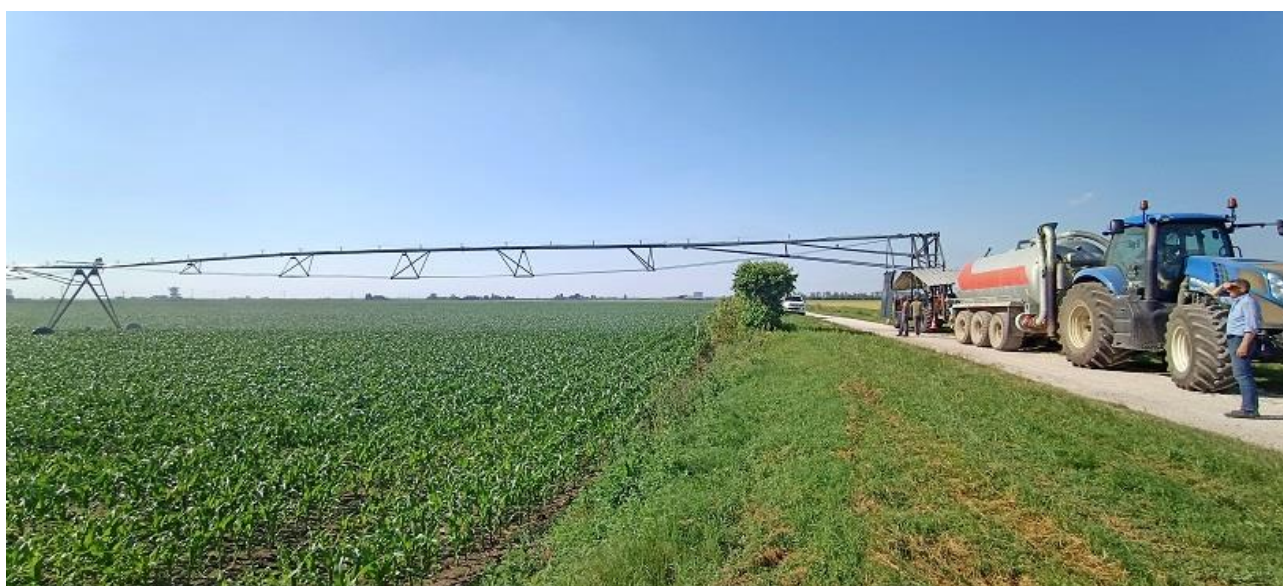
Foto - Operazione di fertirrigazione con acqua e digestato microfiltrato, attraverso sistema di irrigazione lineare ad ali traslanti (rainger)
