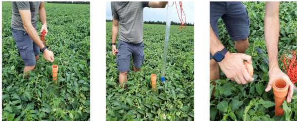
*Immagine del prelievo delle acque da piezometro tramite specifico strumento (bailer)*
