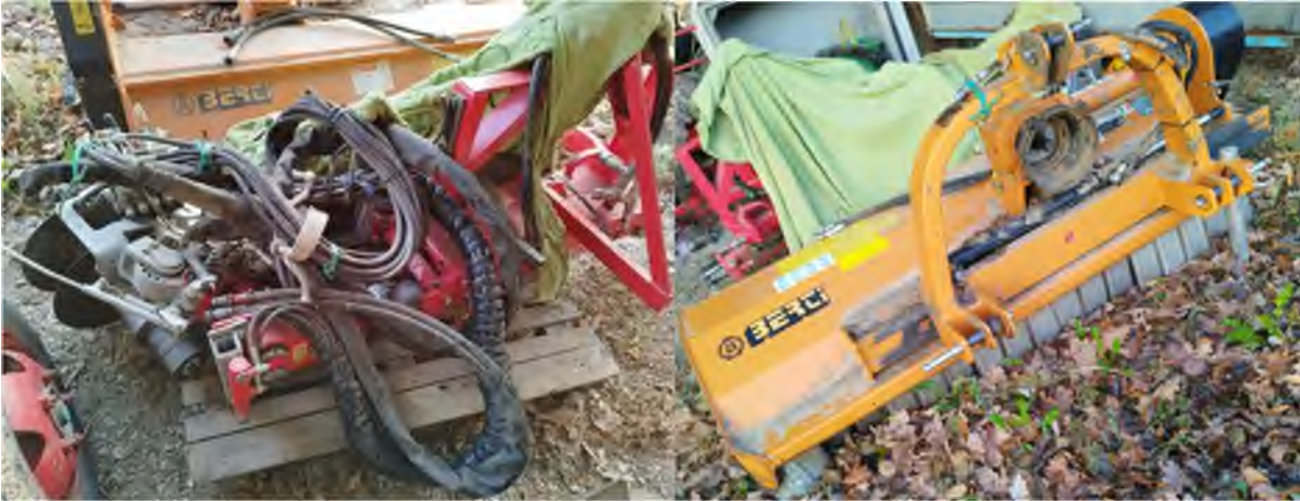
Figura 3.1.3.3. Erpice a dischi tipologia SPEDO per la lavorazione del terreno lungo il filare (a sinistra). Trinciaerba per la trinciatura del cotico erboso nell'interfila (a destra).
