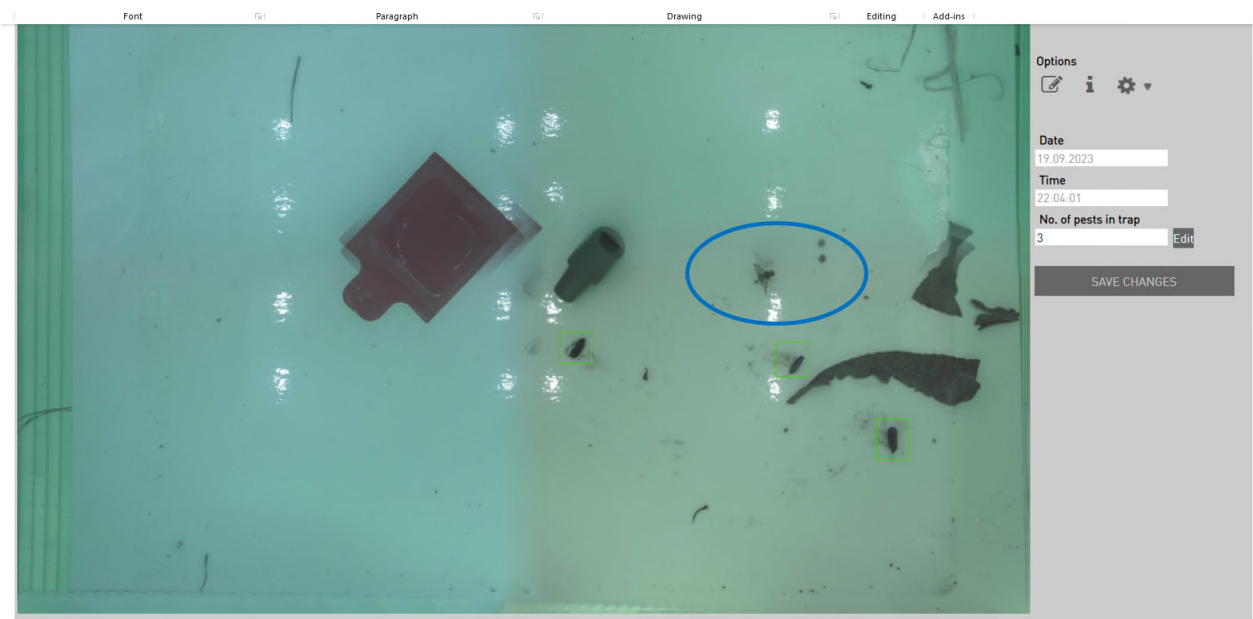
Figura 3.4.13. Dettaglio di un dispositivo automatico Trapview Standard utilizzato nella prova cidia del pesco dove sono presenti 3 riconoscimenti automatici di Grapholita molesta (corrispondenti ad altrettante catture effettive), mentre in modo corretto non è stata riconosciuta ed identificata 1 cattura di Ceratitidis capitata .
