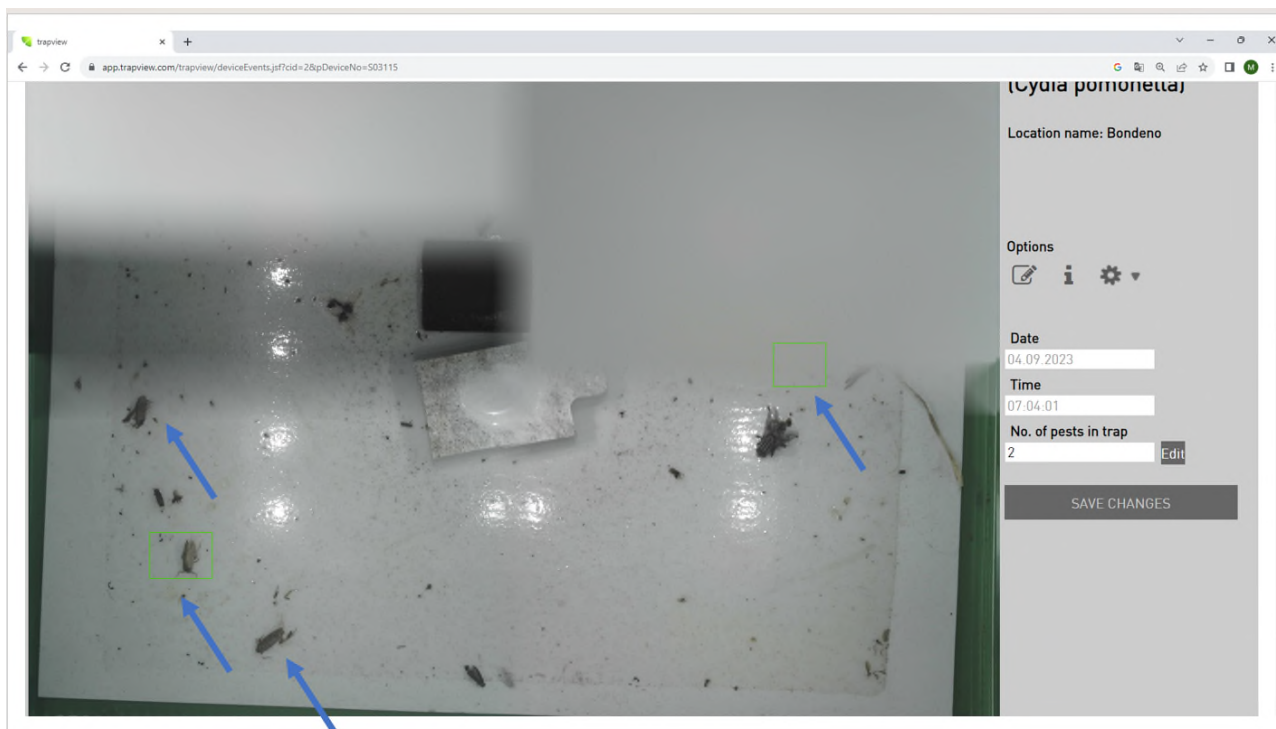
Figura 3.4.11. Dettaglio di un dispositivo automatico Trapview Standard utilizzato nella prova carpocapsa dove è presente un riquadro senza cattura (falso positivo, probabilmente dovuto ad una precedente cattura ancora in memoria in quella posizione) e due carpocapse senza riquadro (falso negativo, non conteggiando la specie target). Una cattura è stata correttamente identificata e conteggiata (la cattura centrale con riquadro verde).
