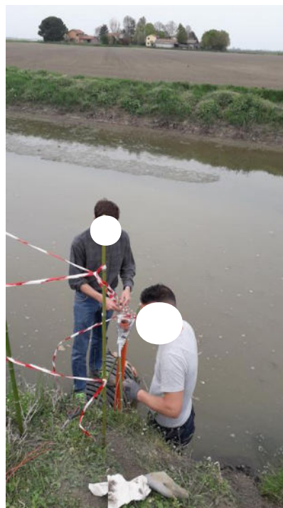
Figura 8: Fasi dell'installazione dei piezometri in prossimità della risaia 2023. A sinistra, acquisizione della quota slm tramite GPS di piezometro. A destra, posa del piezometro sul canale Seminiato.
