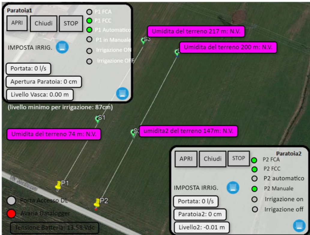
Figura 22: Portale di gestione in remoto delle paratoie
