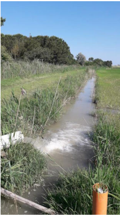
Figura 11: A sinistra, tubo di immissione acque in risaia e tubo arancione di protezione del piezometro. A destra, operazioni di posa del piezometro da 2 m nella zona di scolo delle acque di risaia.
