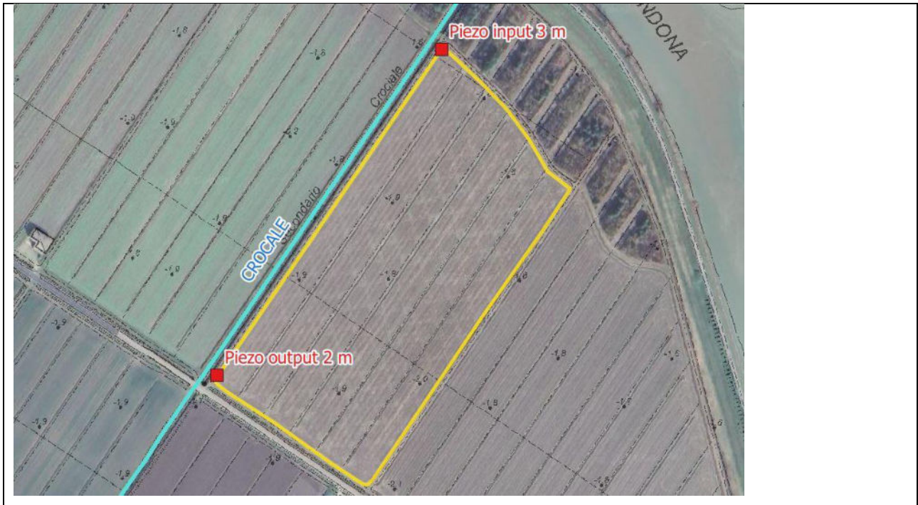
Figura 12: Appezamento a risaia dell'azienda Marangon anno 2023. I quadrati rossi indicano l'ubicazione dei piezometri; in colore giallo i limiti dell'appezzamento; in azzurro i canali irrigui e/o di scolo afferenti all'appezzamento.
