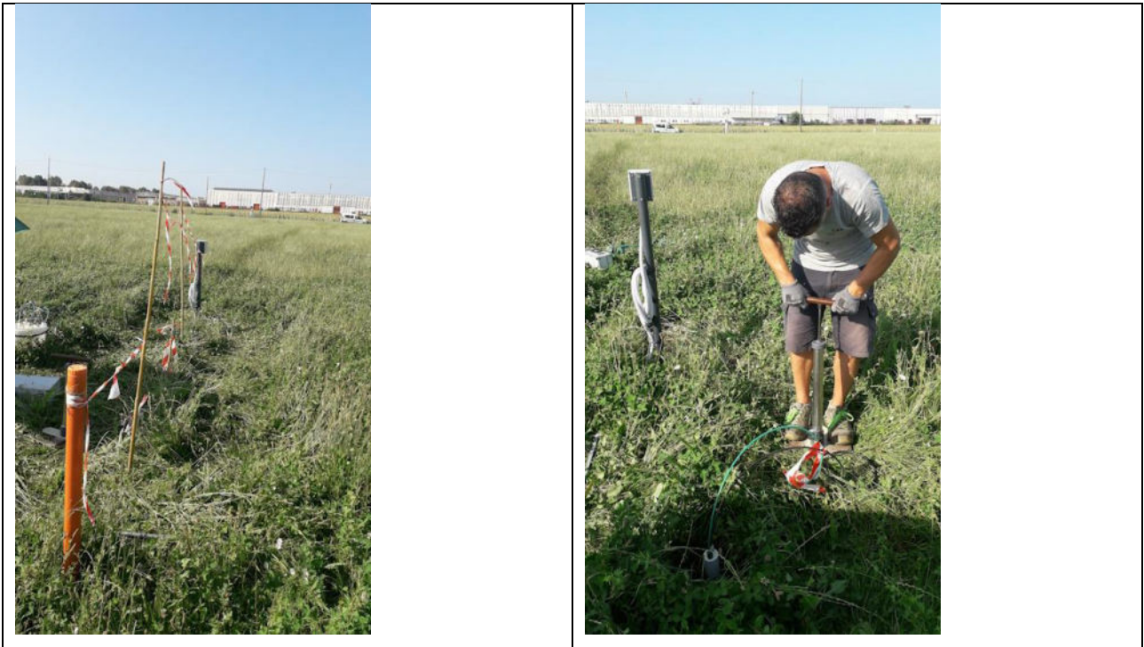
Figura 15: A sinistra, piezometro da 2 m nella parte centrale del campo, assieme alla centralina ETG e nastro segnaletico. A destra, creazione, tramite pompa, del differenziale di pressione rispetto all'atmosfera, in uno dei lisimetri posizionati nel terreno.
