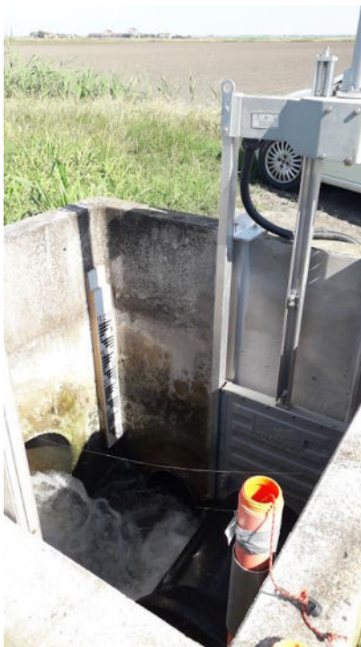
Figura 10: A sinistra, pozzetto in cemento con paratoia automatizzata installata nella primavera 2024: in primo piano, il piezometro fissato alla parete e il TD Diver fissato con un cavo. In basso, si intravede il tubo nero d'invito delle acque all'interno della paratoia. A destra, piezometro installato presso una scolina nella risaia nord.
