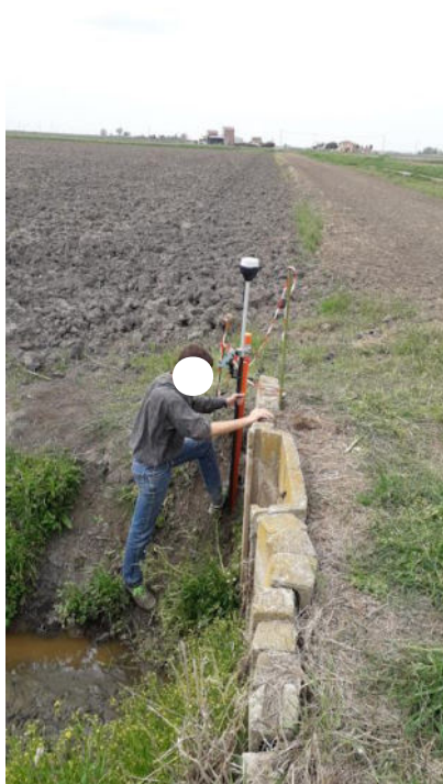
Figura 8: Fasi dell'installazione dei piezometri in prossimità della risaia 2023. A sinistra, acquisizione della quota slm tramite GPS di piezometro. A destra, posa del piezometro sul canale Seminiato.
