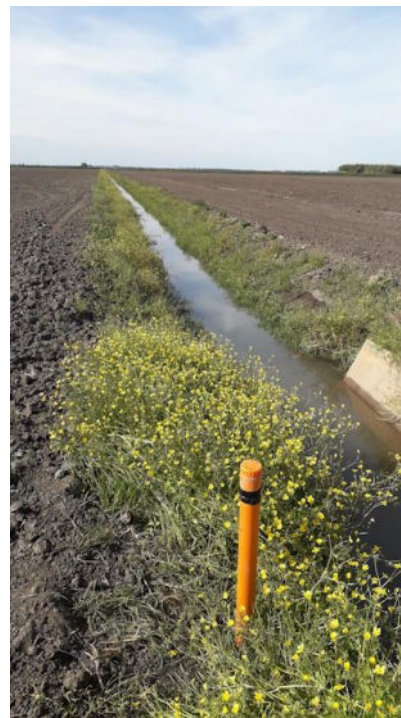
Figura 10: A sinistra, pozzetto in cemento con paratoia automatizzata installata nella primavera 2024: in primo piano, il piezometro fissato alla parete e il TD Diver fissato con un cavo. In basso, si intravede il tubo nero d'invito delle acque all'interno della paratoia. A destra, piezometro installato presso una scolina nella risaia nord.
