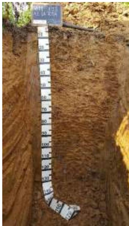
**Oe 5 – 0 cm;** poco umido, colore umido bruno grigio molto scuro (10YR 3/2), screziature assenti, scheletro assente, struttura lamellare fine, debolmente sviluppata; pori principali fini vescicole (0,5 mm, 2%); figure pedogenetiche assenti, radici fini (1 mm) molte (25 radici su 100 cm<sup>2</sup>), effervescenza all'HCl nulla, pH moderatamente acido, limite abrupto ondulato.
