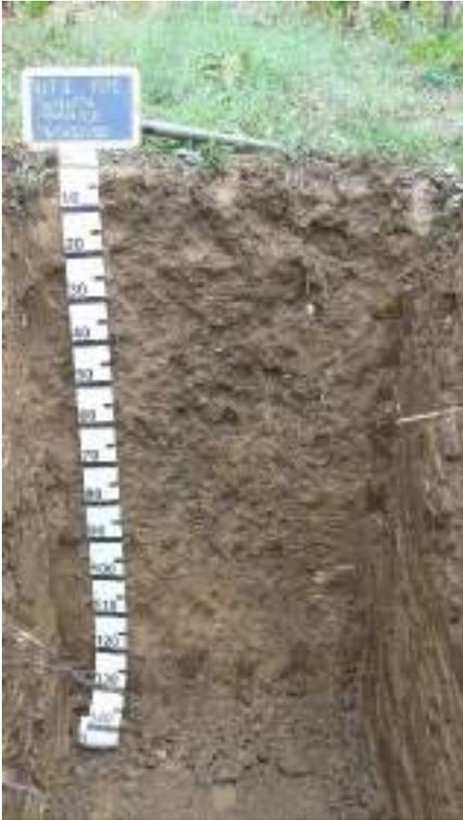
**Oe 2 – 0 cm;** poco umido, colore umido bruno grigio scuro (10YR 4/2), screziature bruno (10 YR 4/3) (10% da 5 mm), scheletro leggermente alterato (3% da 30 mm), struttura principale granulare fine, debolmente sviluppata; pori principali molto fini vescicole (<0,5 mm, 2%), figure pedogenetiche assenti, radici molto grossolane (60 mm) poche (8 radici su 100 cm<sup>2</sup>), effervescenza nessuna, pH debolmente acido, limite chiaro lineare.
