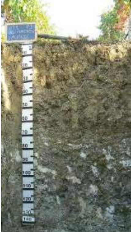
molto fine, moderatamente sviluppata; pori principali fini (1 mm, 15 %), pori secondari medi (3 mm, 0,5%); figure pedogenetiche di precipitazione di carbonati o sali masse non cementate di carbonato di calcio di forma cilindrica all'interno di vuoti (2% da 7 mm) e masse cementate di carbonato di calcio di forma cilindrica, all'interno di vuoti (0,5% da 10 mm), radici medie (4 mm) molte (8 radici su 100 cm<sup>2</sup>), effervescenza violenta, pH moderatamente alcalino, limite graduale lineare.
