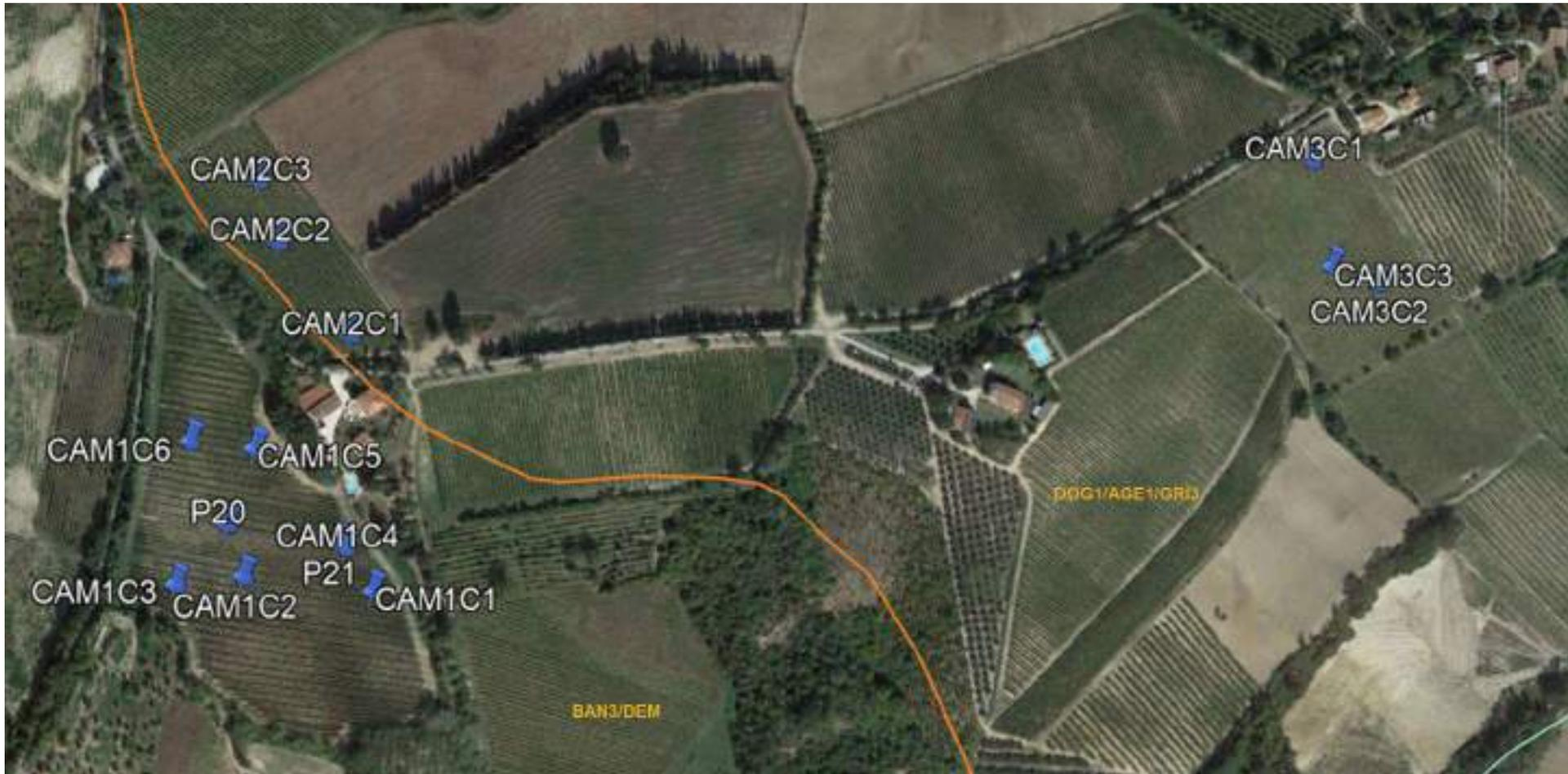
Localizzazione in Google Earth delle 12 trivellate eseguite (CAM1C1, CAM1C2, CAM1C3, CAM1C4, CAM1C5, CAM1C6; CAM2C1; CAM2C2; CAM2C3; CAM3C1; CAM3C2; CAM3C3)
