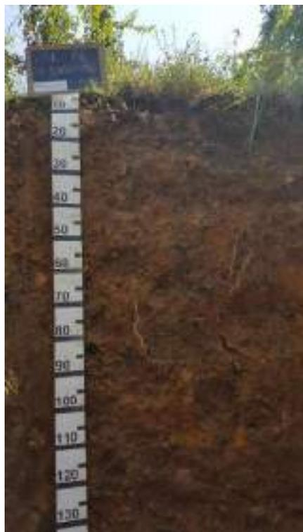
**Oe 3 – 0 cm**; secco, colore umido bruno grigio molto scuro (10YR 3/2), screziature assenti, scheletro assente, struttura lamellare fine, moderatamente sviluppata; pori principali molto fini vescicole (0,5 mm, 0,5%); figure pedogenetiche assenti, radici fini (1 mm) comuni (20 radici su 100 cm<sup>2</sup>), effervescenza all'HCl nulla, pH fortemente acido, limite graduale ondulato.
