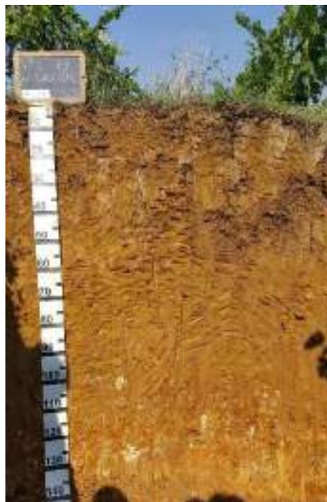
**Oe 2 – 0 cm;** secco, colore umido bruno grigio molto scuro (10YR 3/2), screziature assenti, scheletro assente, struttura lamellare fine, moderatamente sviluppata; pori principali fini vescicole (2 mm, 0,1%); figure pedogenetiche assenti, radici molto fini (0,5 mm) comuni (20 radici su 100 cm<sup>2</sup>), effervescenza all'HCl nulla, pH neutro, limite graduale ondulato.
