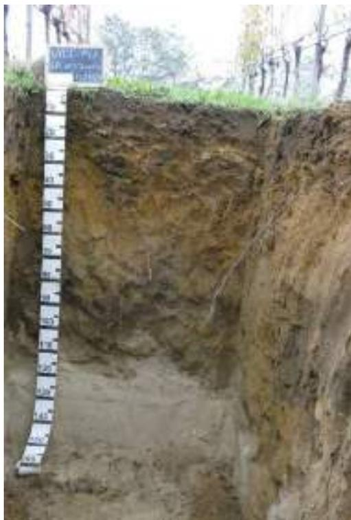
**A 0-5 cm;** umido, franco sabbioso, colore umido bruno (10 YR 4/3), screziature assenti, scheletro assente, struttura principale granulare fine, debolmente sviluppata; pori principali medi (3 mm, 5%), pori secondari fini (1 mm, 2%); figure pedogenetiche assenti, radici assenti, nessuna reazione all'HCl, pH debolmente alcalino, limite chiaro lineare.
