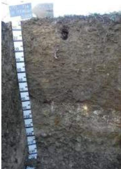
**Oi 2 – 0 cm;** umido, colore umido bruno oliva scuro (2.5Y 3/4), screziature assenti, scheletro leggermente alterato (3% da 4 mm), struttura principale grumosa media, debolmente sviluppata, struttura secondaria grumosa fine, debolmente sviluppata; pori principali fini vescicole (1 mm, 0,5%), pori secondari medi vescicole (3 mm, 0,5%); figure pedogenetiche assenti, radici fini (1 mm) comuni (20 radici su 100 cm<sup>2</sup>), effervescenza all'HCl forte, limite abrupto lineare.
