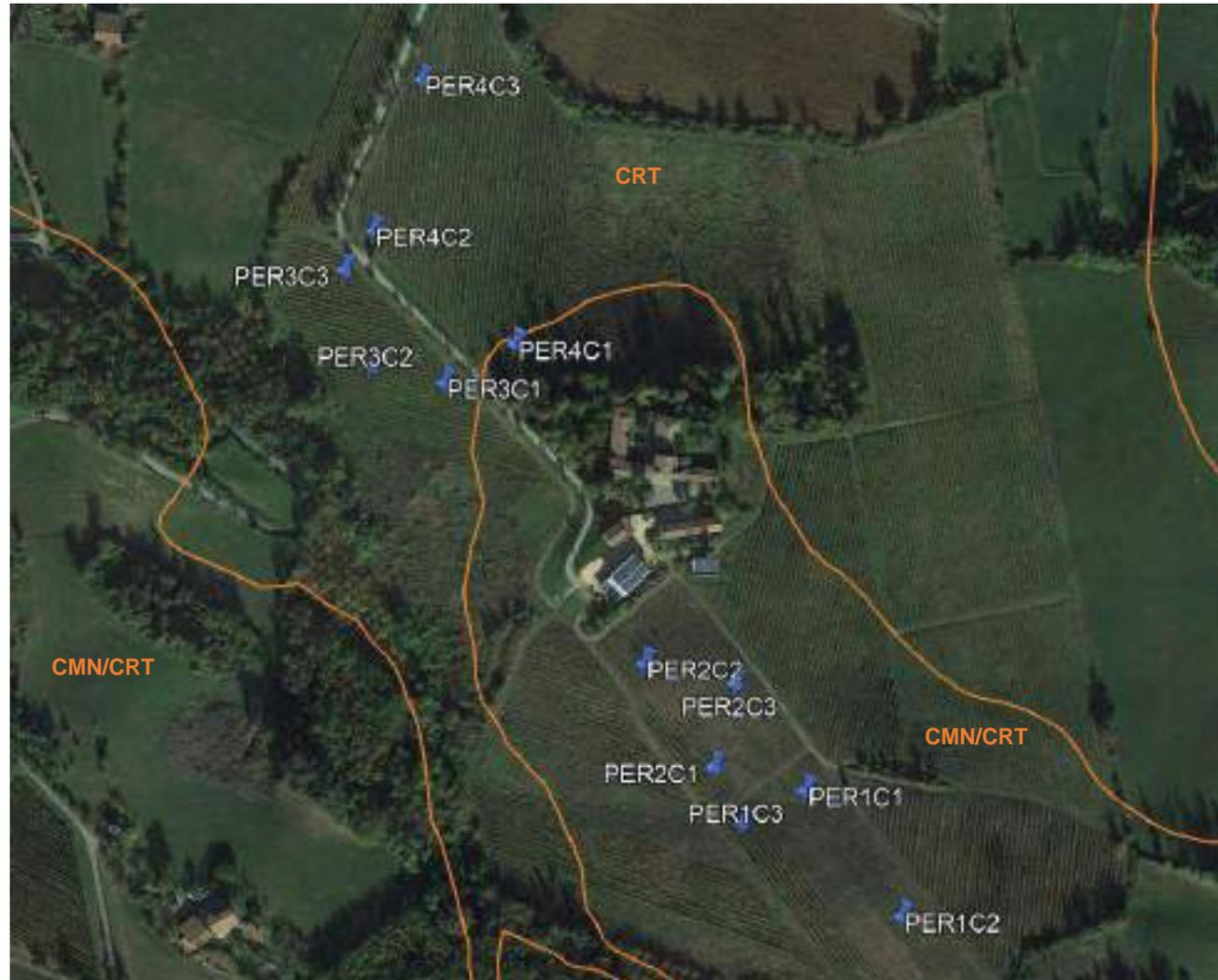
Localizzazione in Google Earth delle 12 trivellate eseguite (PER1C1, PER1C2, PER1C3, PER2C1, PER2C2, PER2C3; PER3C1; PER3C2; PER3C3; PER4C1; PER4C2; PER4C3)
