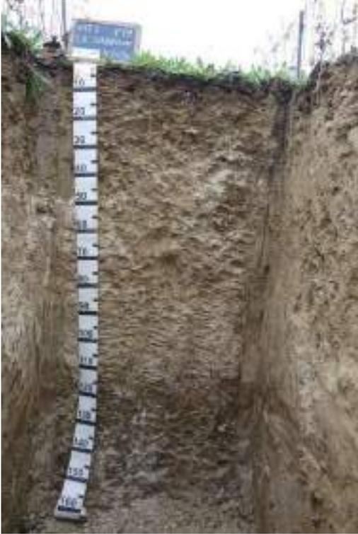
**Oe 2 – 0 cm;** umido, colore umido bruno (10 YR 4/3) e bruno giallastro scuro (10 YR 4/5), screziature assenti, scheletro assente, struttura principale poliedrica subangolare grossolana, moderatamente sviluppata, struttura secondaria granulare fine, debolmente sviluppata; pori principali medi (3 mm, 2%), pori secondari fini (1 mm, 1%); figure pedogenetiche assenti, radici assenti, effervescenza all'HCl violenta, limite chiaro lineare.
