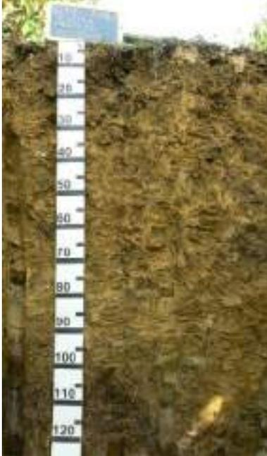
**Oe 1 – 0 cm**; poco umido, colore umido bruno giallastro scuro (10YR 4/4), screziature bruno giallastro (10 YR 5/6) (2% da 1 mm), scheletro assente, struttura granulare fine, debolmente sviluppata; pori assenti, figure pedogenetiche assenti, radici assenti, effervescenza nessuna, pH neutro, limite graduale lineare.
