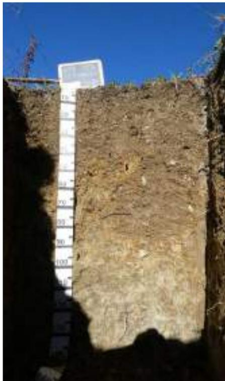
**Oe 2 – 0** cm; umido, colore umido bruno rossastro scuro (2.5YR 3/4), screziature assenti, scheletro assente, struttura grumosa media, moderatamente sviluppata; pori assenti; figure pedogenetiche assenti, radici assenti, limite abrupto lineare.
