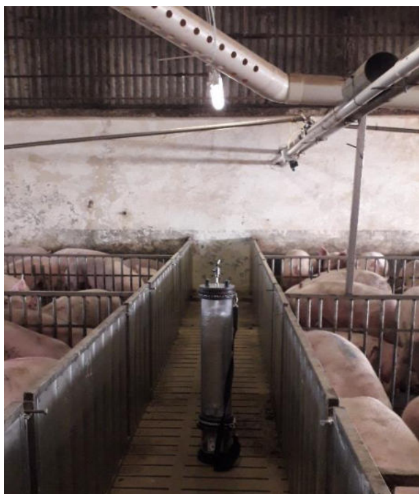
Figura 10 – Alcune immagini delle attività di campionamento: a sinistra il prelievo di aria da sottoporre ad analisi olfattometrica, a destra l'installazione dell'analizzatore fotoacustico gas (INNOVA Multi Gas Monitor Mod. 1412).
