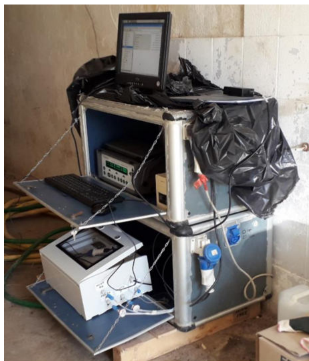
Figura 10 – Alcune immagini delle attività di campionamento: a sinistra il prelievo di aria da sottoporre ad analisi olfattometrica, a destra l'installazione dell'analizzatore fotoacustico gas (INNOVA Multi Gas Monitor Mod. 1412).
