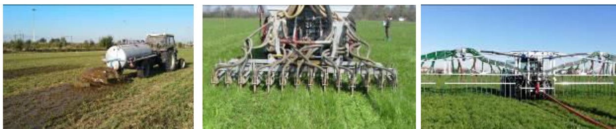
Figura 17 – Tre diverse modalità di applicazione del digestato: a sinistra a spaglio su tutto campo, al centro mediante leggero interrimento con dischi assolcatori e a destra distribuzione a bande superficiali con sistema ombelicale
