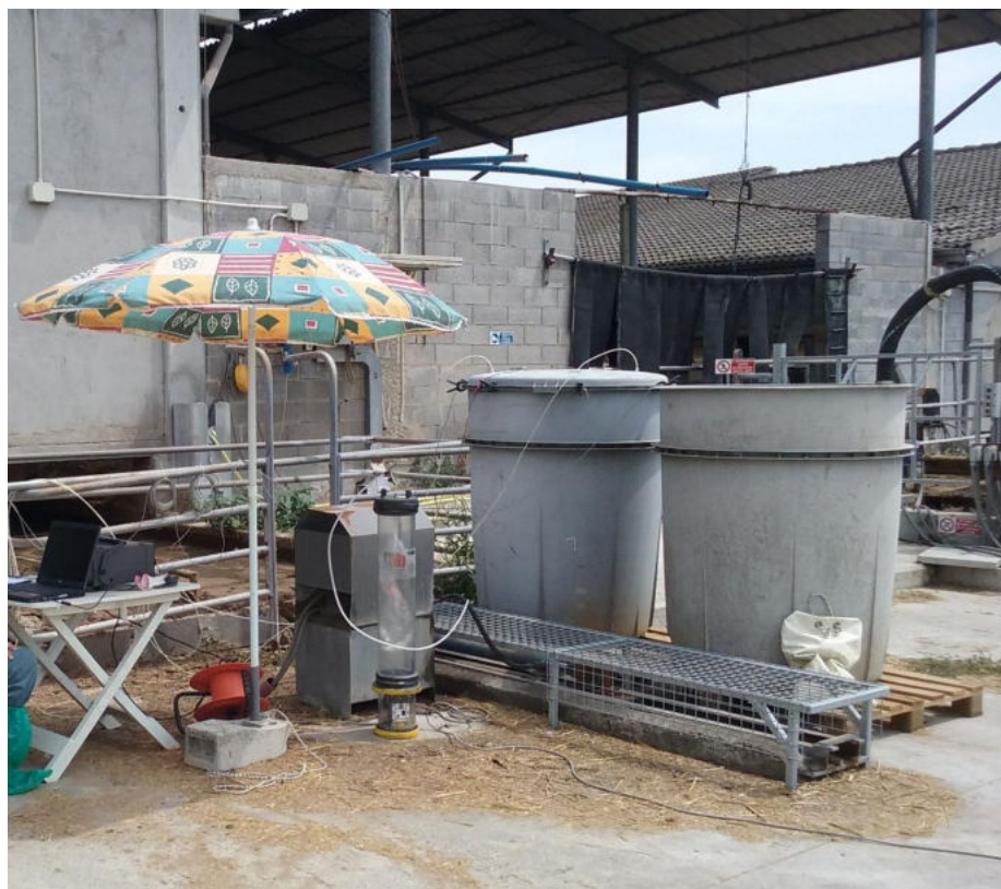
Figura 2 - Strumentazione sperimentale impiegata e tecnica di misura “Static chamber” adottata per il rilievo delle emissioni dagli stoccaggi pilota.
