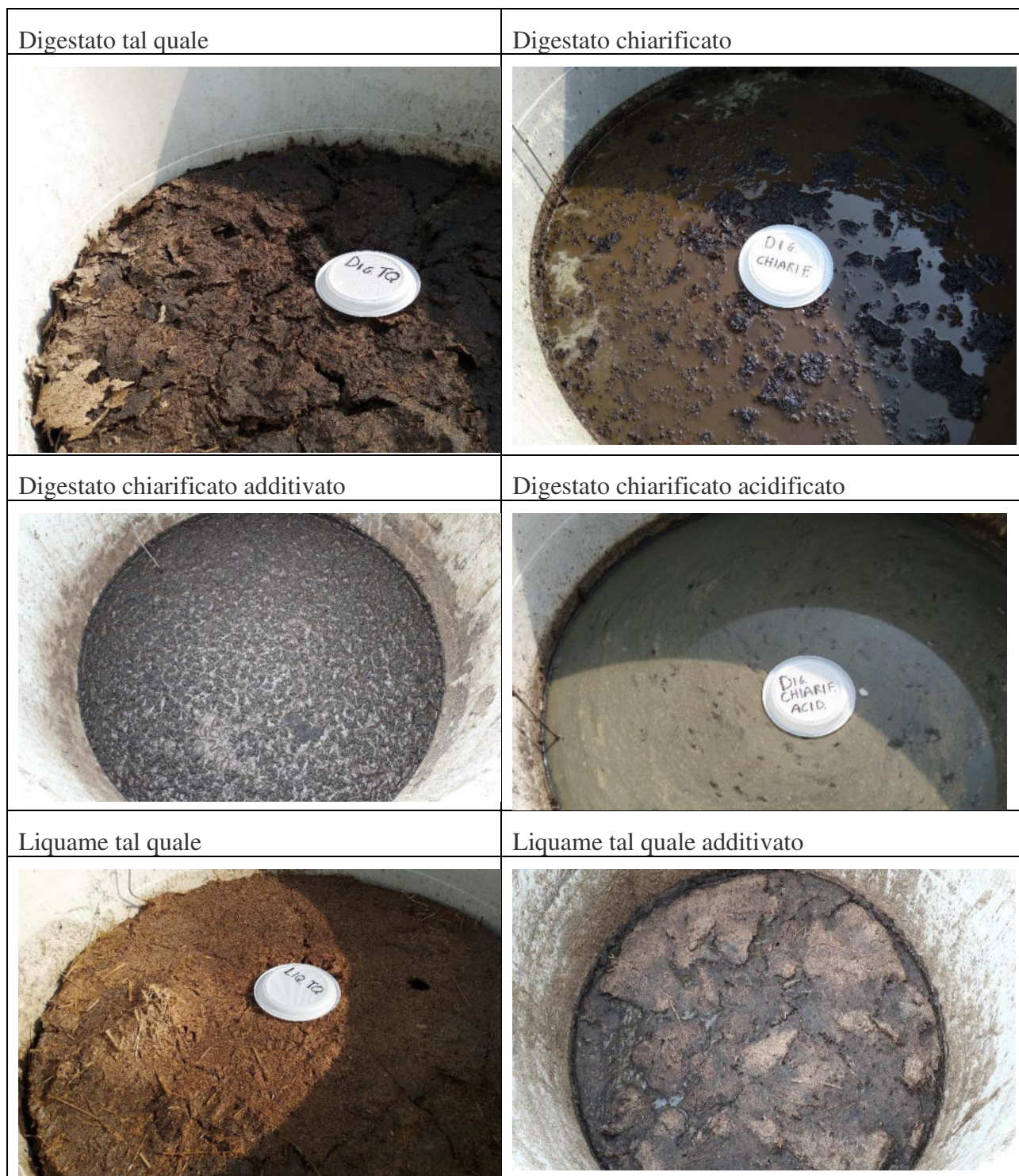
Figura 1 - 6 stoccaggi dinamici pilota da 1 m 3 ed aspetto delle diverse matrici liquide monitorate.
