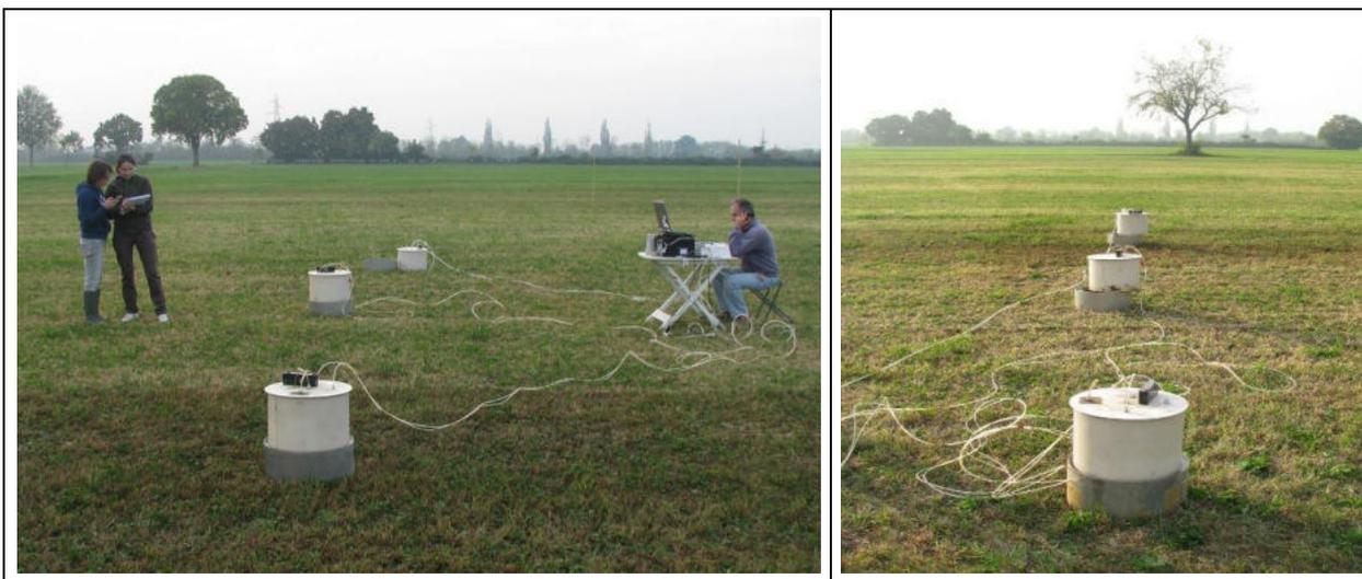
**Foto 4** – Attrezzature di campo impiegate nelle attività per il monitoraggio delle emissioni di protossido d'azoto dal suolo (“Camere statiche” ed analizzatore fotoacustico Multi Gas INNOVA).
