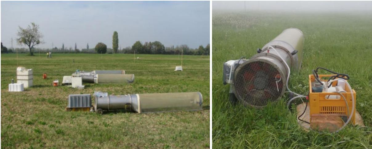
**Foto 3** – Attrezzatura di campo impiegata nel monitoraggio delle emissioni di ammoniaca in seguito agli spandimenti di effluenti zootecnici (Tunnel a vento).
