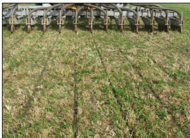
**Foto 2** – Il carro-botte con attrezzo per distribuzione in bande utilizzato nella prova e le due modalità di spandimento superficiale (S) e in bande con leggero interramento (I).
