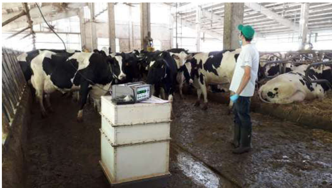
Figura 4.15 – Rilievo delle emissioni dalle superfici delle corsie della stalla, applicando la tecnica della “Static Chamber” con analizzatore Fotoacustico Multigas
