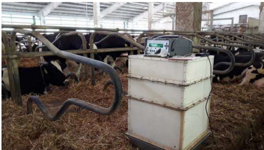
Figura 4.16 – Rilievo delle emissioni dalla superficie delle cuccette, applicando la tecnica della “Static Chamber” con analizzatore Fotoacustico Multigas (INNOVA 1412).
