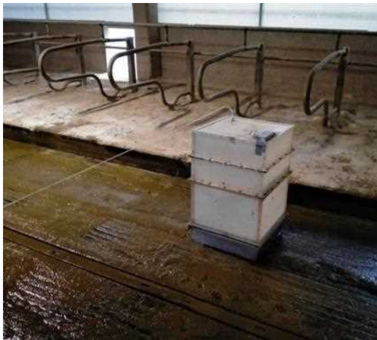
Figura 4.2 – Rilievo delle emissioni dalle superfici delle corsie
