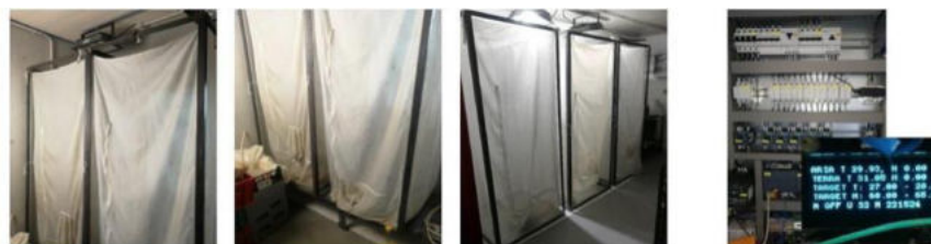
Figura 6 Insettiere e PLC per controllo in remoto presso l'azienda STUARD
