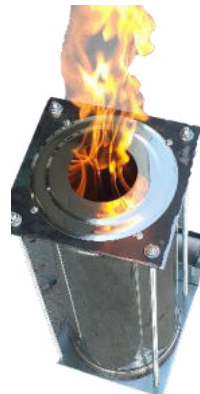
Figura 14 : Micro impianto di carbonizzazione – introduzione biomassa umida con arresto di fiamma
