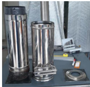
Figura 14 : Micro impianto di carbonizzazione – introduzione biomassa umida con arresto di fiamma
