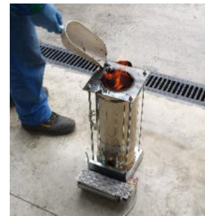
Figura 14 : Micro impianto di carbonizzazione – introduzione biomassa umida con arresto di fiamma
