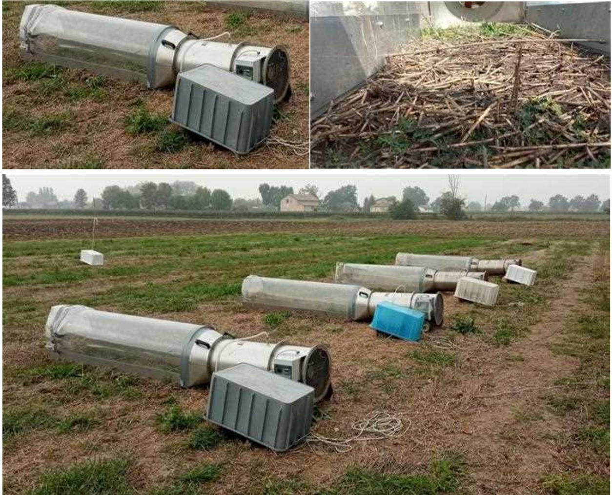
**Figura 11** – Attività di misura delle emissioni ammoniacali mediante la tecnica del tunnel a vento che consente di quantificare in condizioni controllate le emissioni da piccole superfici di distribuzione - Lockyer (1984), Ryden & Lockyer (1985) e Meisinger et al. (2011).
