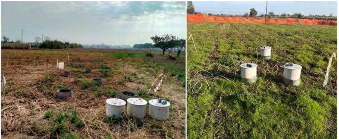
Figura 12 – Attività di monitoraggio delle emissioni di GHG dal suolo.
