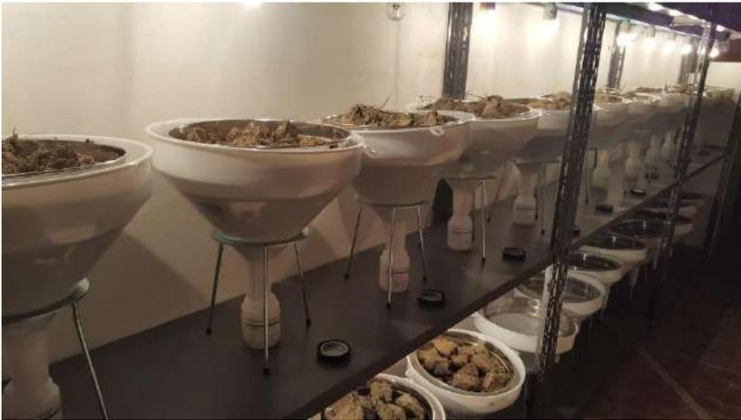
*Esempio estrattori di Berlese Tüllgren per l'estrazione di microartropodi pedafici per l'applicazione dell'indice QBS-ar*
