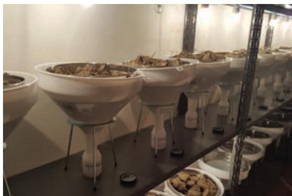
Foto 4 - Esempio estrattori di Berlese Tullgren per l'estrazione di microartropodi pedafici per l'applicazione dell'indice QBS-ar
