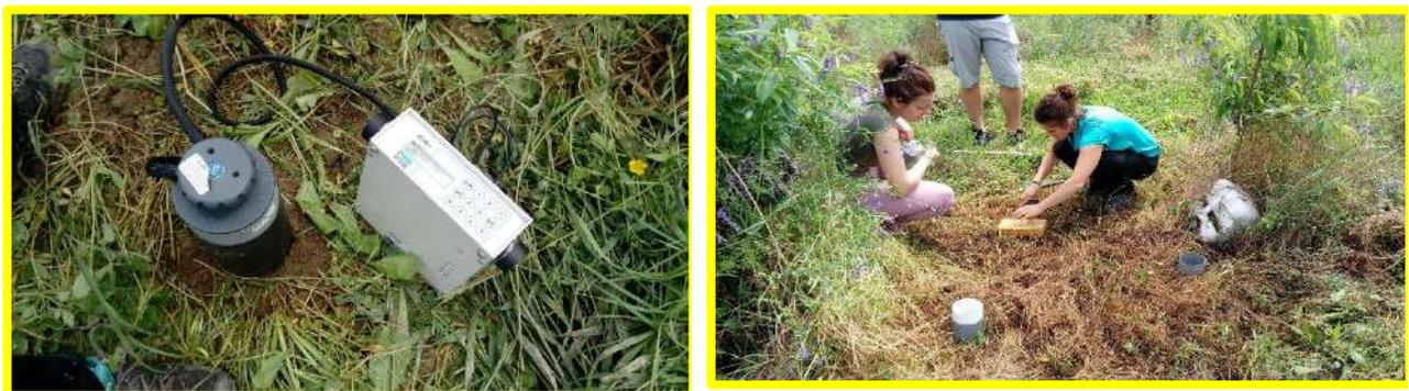
**Fig. 29.** Misuratore portatile di CO<sub>2</sub> EGM4\_PP System e posizionamento dei collari
