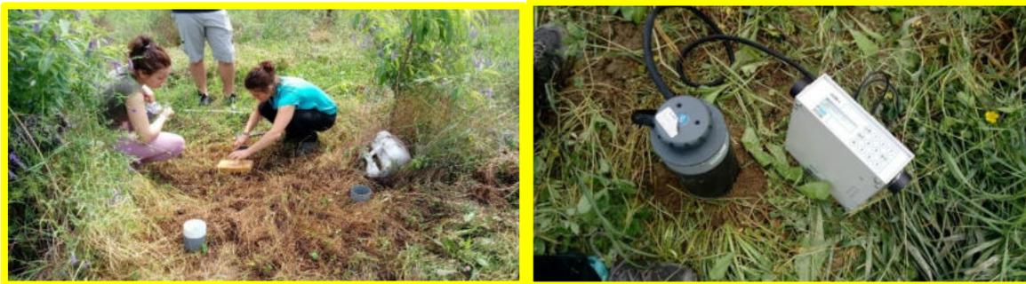
**Fig. 28.** Misuratore portatile di CO<sub>2</sub> EGM4\_PP System e posizionamento dei collari
