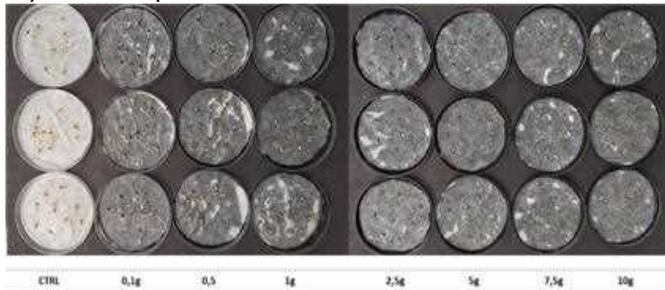
Figura 2: Test di germinazione in vitro come da protocollo UNICHIM Met 1651-2003. Immagini delle piastre contenenti quantità crescenti (0 g; 0,1 g; 0,5 g; 1 g; 2,5g; 5g; 7,5g; 10 g) di char, su cui sono stati fatti germinare semi di Lepidum sativum per 72 h.
