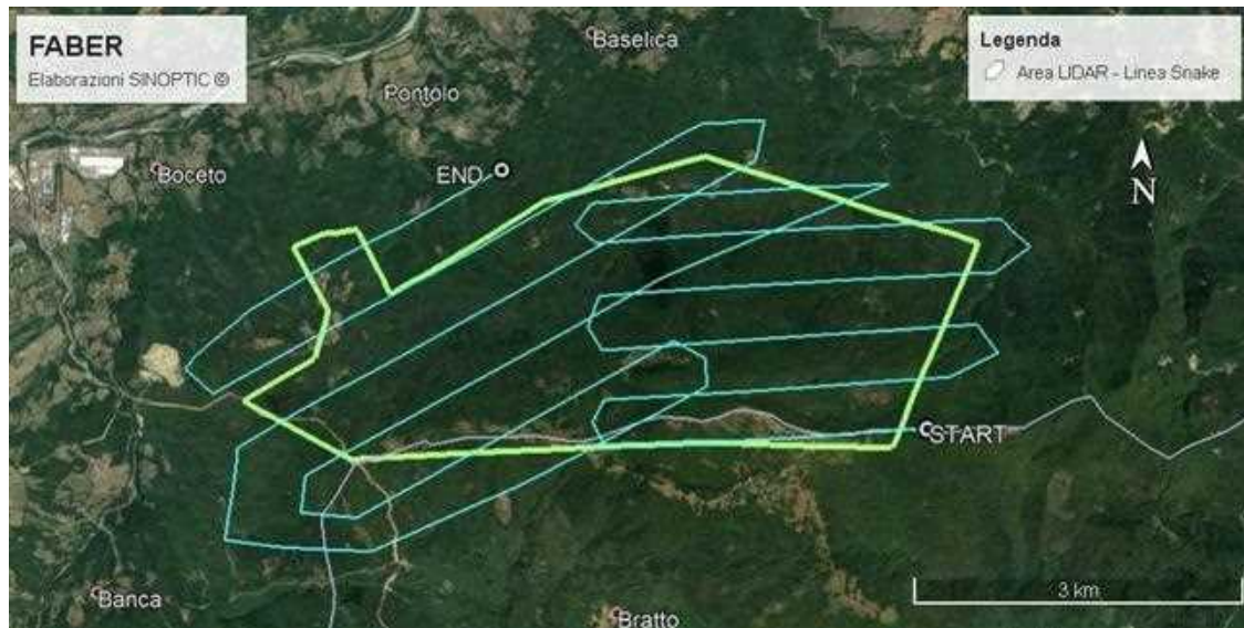
Figura 4.2: Linee di volo (Snake – Flight lines) del piano di volo eseguito, con punti d'inizio e fine.
