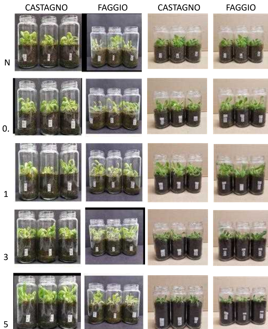
Figura 3: Test di fitotossicità in vivo su Lactuca sativa L. come da protocollo BURL13/05/03. Immagini dei dispositivi contenenti suolo come da protocollo ammendato con dosi crescenti (0,5%,
