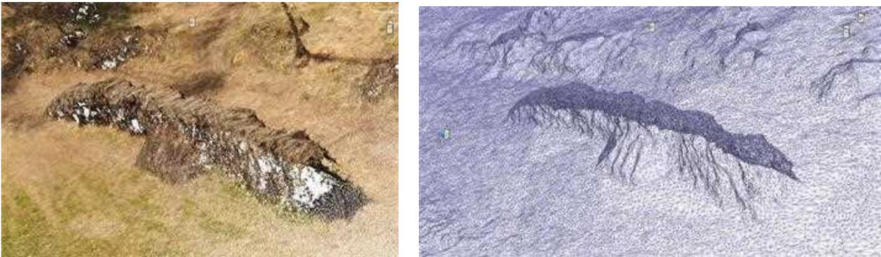
Dettaglio della nuvola di punti e delle mesh
