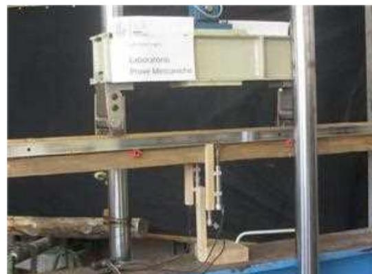
Attrezzatura montata sulla macchina MetroCOM per la determinazione dei moduli elastici delle travi
