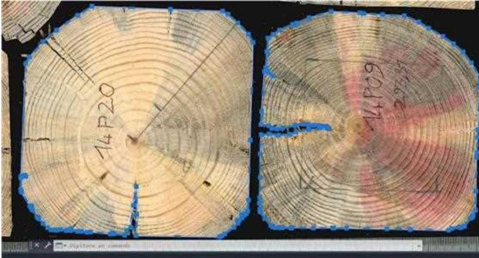
*Misurazione di precisione per i provini del pino UF al fine di determinare il volume e la densità*
