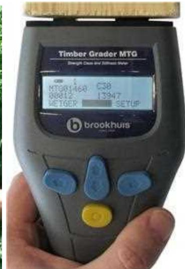
Misure con il Timber Grader. A destra esempio di esiti della classificazione con modulo elastico e resistenza
