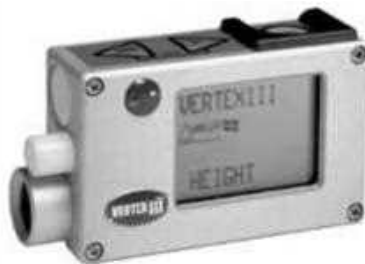
FIGURA 2.3.1-5. VERTEX III (HAGLÖF, SWEDEN AB) USATO PER LA MISURAZIONE DELL'ALTEZZA DEGLI INDIVIDUI SELEZIONATI.
