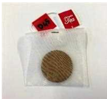
FIGURA 2.3.4-2. DISCO DI FAGGIO TRATTATO CON UNA SOLUZIONE DI ACIDO TANNICO AL 5% E INSERITO IN UNA BUSTINA DI TÈ.
