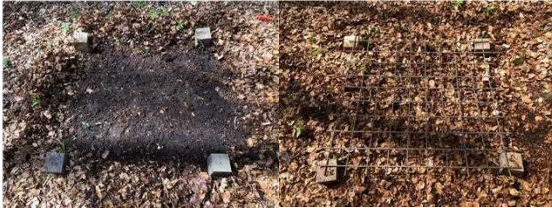
FIGURA 2.3.4-4. PREPARAZIONE DEL PLOT PER IL POSIZIONAMENTO DEI CAMPIONI (SINISTRA); PLOT RICOPERTO DI LETTIERA E PROTETTO DALLA GRIGLIA METALLICA (DESTRA).
