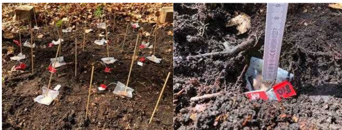
FIGURA 2.3.4-3. DISCHI DI FAGGIO ESPOSTI SIA SUL SUOLO FORESTALE CHE A -5 CM DALLA SUA SUPERFICIE. DOPO AVER POSIZIONATI I CAMPIONI LE AREE SONO STATE RICOPERTE USANDO LA LETTIERA PRECEDENTEMENTE RIMOSSA.
