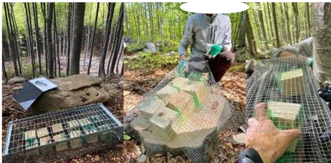
FIGURA 2.3.2-2. CUBI DI FAGGIO APPOGGIATI AL SUOLO (SINISTRA), APPOGGIATI SU UNA CEPPAIA (CENTRO) E POSIZIONATI SOPRA UNA CATASTA DI LEGNA (DESTRA). TUTTI I CUBI SONO STATI PROTETTI DA GRIGLIE METALLICHE PROGETTATE E COSTRUITE PER EVITARE POSSIBILI DISTURBI DA PARTE DI ANIMALI SELVATICI.
