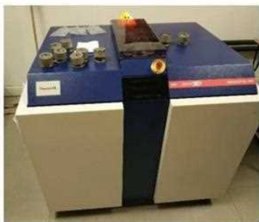
Figura 6. Foto dello spettrometro a fluorescenza a raggi-X (XRF) e uno schema riassuntivo delle sue componenti principali.
