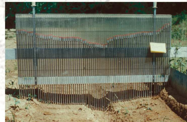
Profilografo (per misura rigagnoli)
