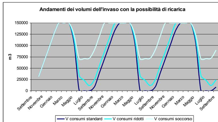
Il volume di 150.000 m<sup>3</sup> è sufficiente sia nel caso di irrigazioni di soccorso che di consumi ridotti, se si adottasse invece la strategia del pieno soddisfacimento idrico l'invaso si vuoterebbe anzitempo a fine giugno. La possibilità di ricaricare l'invaso anche durante la stagione irrigua permette di ridurre le dimensioni dell'invaso disponendo allo stesso tempo di maggiori volumi d'acqua utilizzabili durante tutto il periodo irriguo.
