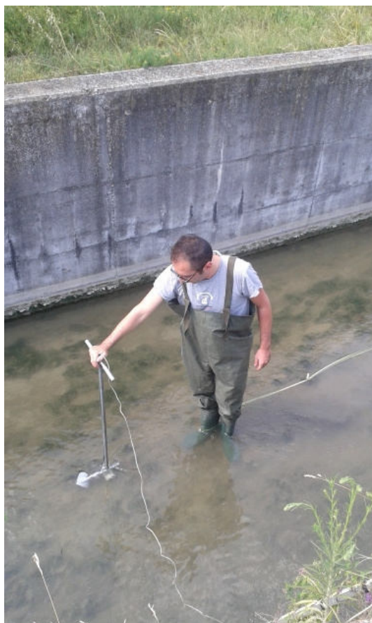
Figura 5: rilievi della velocità del flusso con mulinello Siap C31
