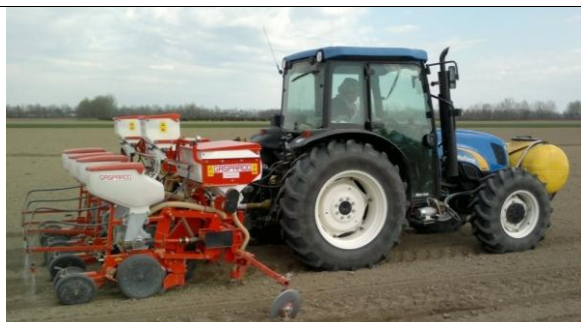
irroratrici abbinati a seminatrici o sarchiatrici (larghezza banda trattata > 3 metri)
