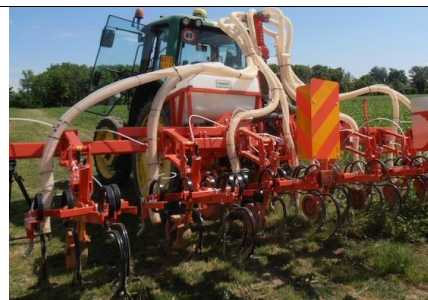
irroratrici abbinati a seminatrici o sarchiatrici (larghezza banda trattata > 3 metri)
