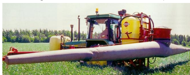
per pressione con manica d'aria
