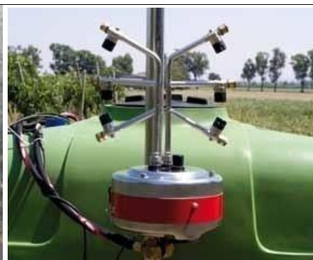
irroratrici con ugelli a movimento oscillatorio
