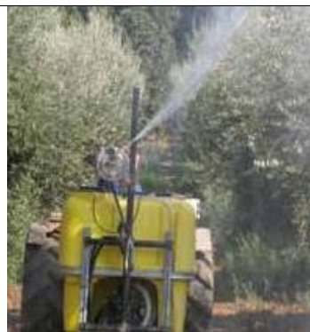
irroratrici con ugelli a movimento oscillatorio
