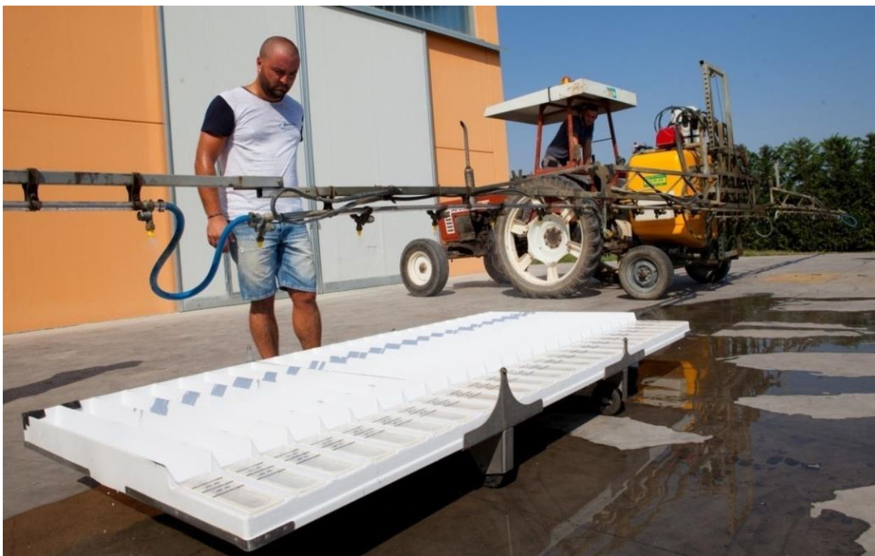
Regolazione strumentale di una barra irroratrice - Determinazione della corretta altezza di lavoro
